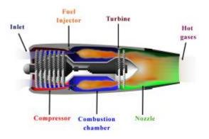
圖 2-1 噴射引擎之工作流體,由外界吸入,PV 狀態 經 0--23(壓縮)--34(燃燒升溫)--45(膨脹對渦輪(turbine)作工)--58(回到外界降溫),順時針
