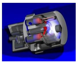
圖 4-4 瑞尼那組合(示意圖);實際運用時將四個汽缸 和活塞組合成環形,利用斜盤 (透視圖的左 方)維持相鄰活塞運動的相位差。
