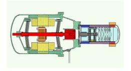
圖 4-5 美國太空總署研發的自由活塞型史特林引擎,無機械式的連動機構,活塞(紅色)和移氣 胴體(右方淡藍色)之運動仍具有必要的相位 差。
