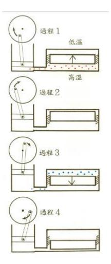
圖 3-1 史特林引擎示意圖,右方溫差氣室兩側斜線 部分代表『熱再生器(regenerator)』。
