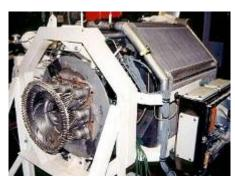
圖 6-4 4 氣缸 α型史特林引擎(4-95 Mark II )之示意 圖,以及實物攝影(鎳基超合金細管製成的熱 區(receiver)清晰可見)
