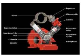
圖 4-3 α 型史特林引擎,示意圖顯示工作流體藉著兩個活塞密封在高溫(左下方火焰處)和低溫的兩個汽缸之內,兩個活塞作相位差 90°的往復運動。透視圖顯示實際引擎的造型。
